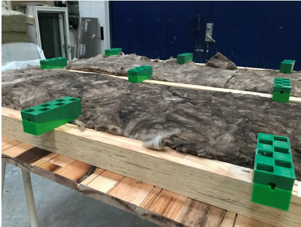
Figur 3 Bunden af gulvkonstruktionen af Kombi Top Stor og Kombi Top Mellem kiler uden lydbrik.
